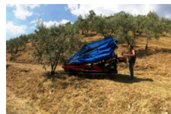
La versione semovente a cingoli Climb consente di operare in sicurezza su pendenze e terrazzamenti.
